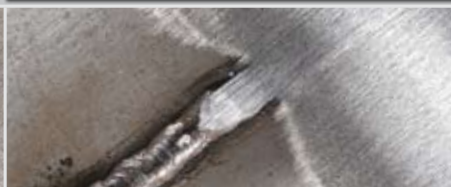
4 Zestaw do stali szlachetnej, przygotowanie do polerowania powierzchni płaskich/rur/profilu
